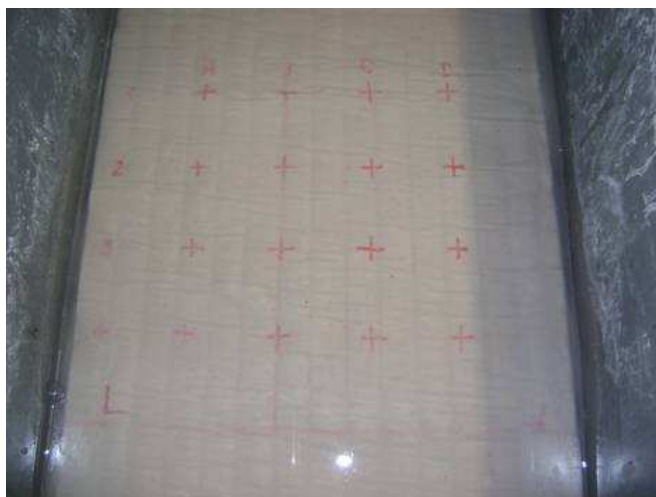
Figura 5.8 – Imersão de amostra de GCL em tanque com 50 mm de coluna d'água.
