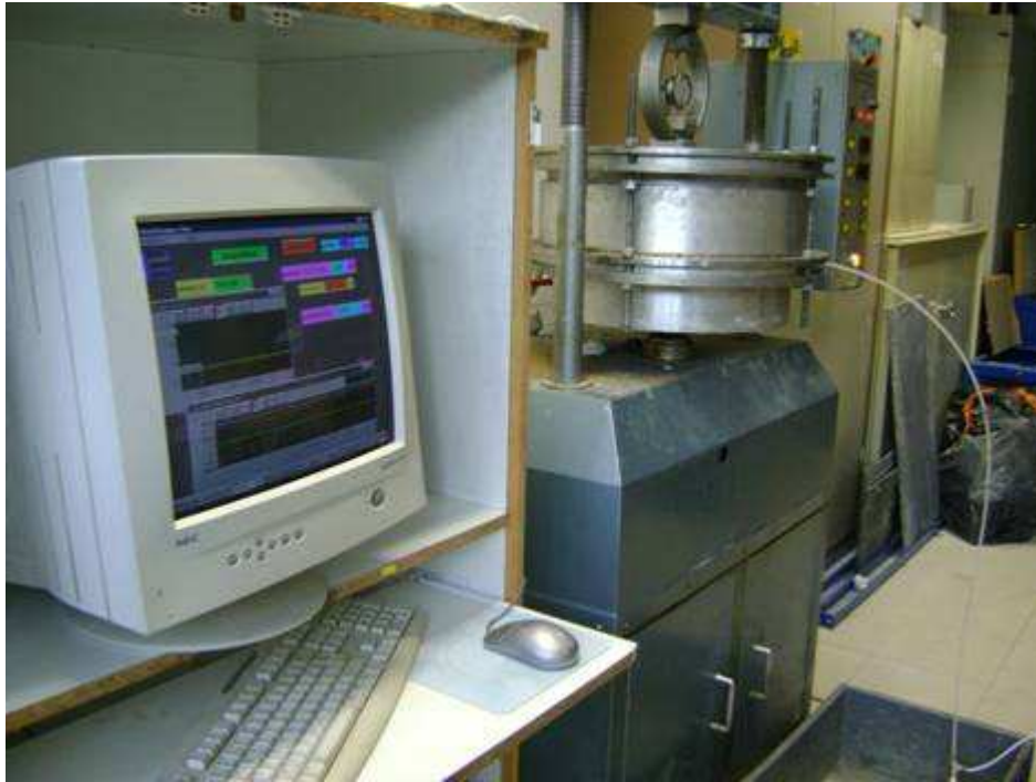
Figura 5.3 – Detalhe do sistema de aquisição automática de dados.
