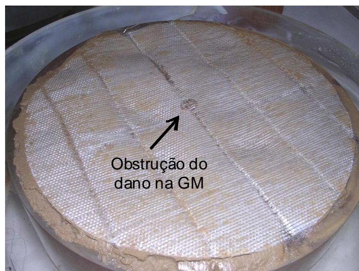
Figura 8.7 – Expansão da bentonita no GCL 1-S: amostra de GCL após o ensaio 1.S-10b - expansão da bentonita selando o furo da geomembrana no ensaio.
