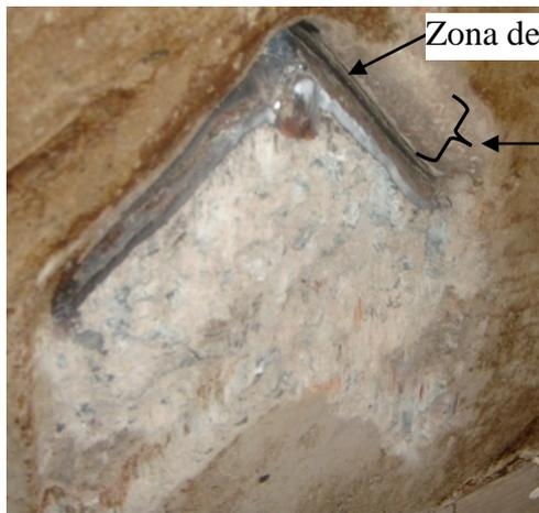
(c) Detalhe da região do conector 'V'-100 mm
