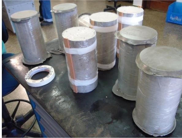
Figura 5.1 - Preparação dos corpos-de-prova de concreto
