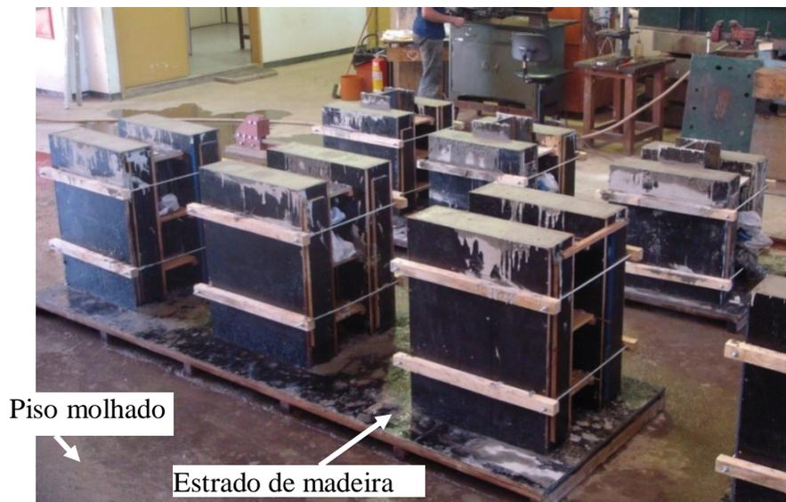
Figura 4.13 - Controle da umidade das peças
