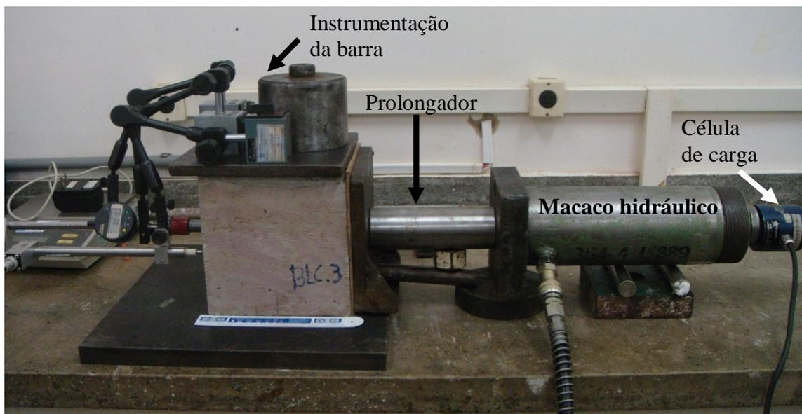
Figura 4.34 - Montagem do experimento de arrancamento.
