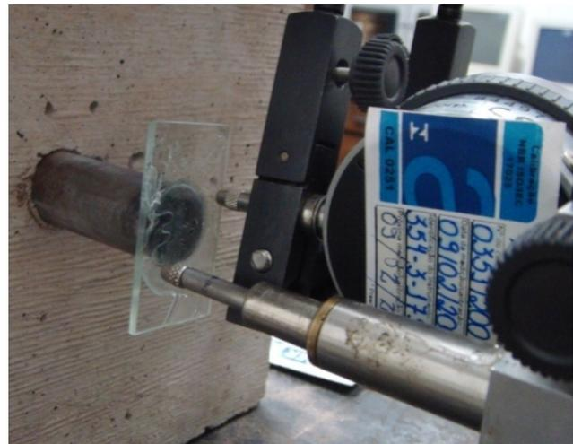
(b) Apoio dos sensores na placa de vidro
