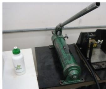
Figura 4.40 Bomba utilizada na aplicação da carga
