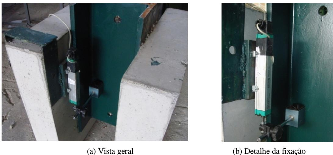
Figura 4.22 - Fixação do segundo defletômetro vertical (ensaios finais)
