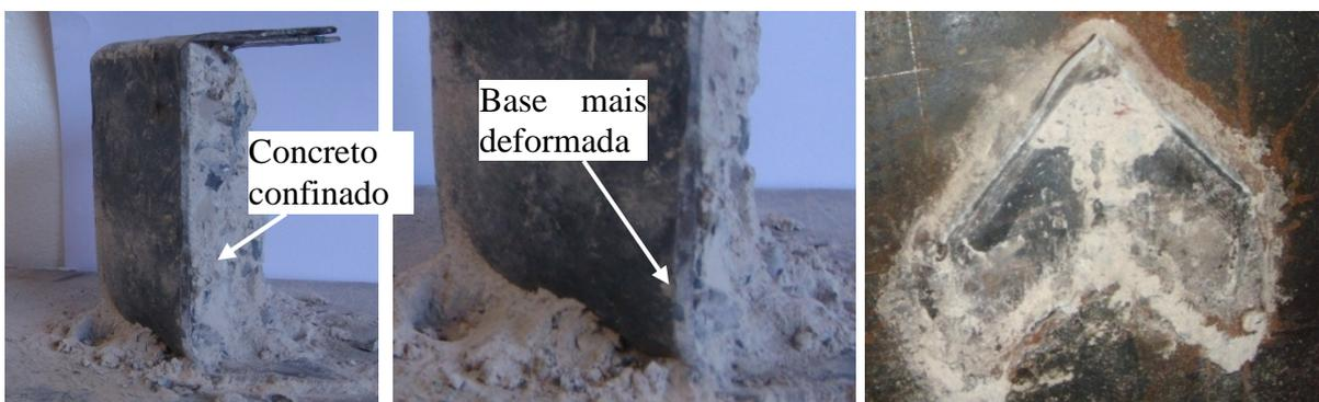
(a) Conector ‘V’-130 mm      (b) Detalhe da região da base      (c) Base do ‘V’ preso ao perfil
