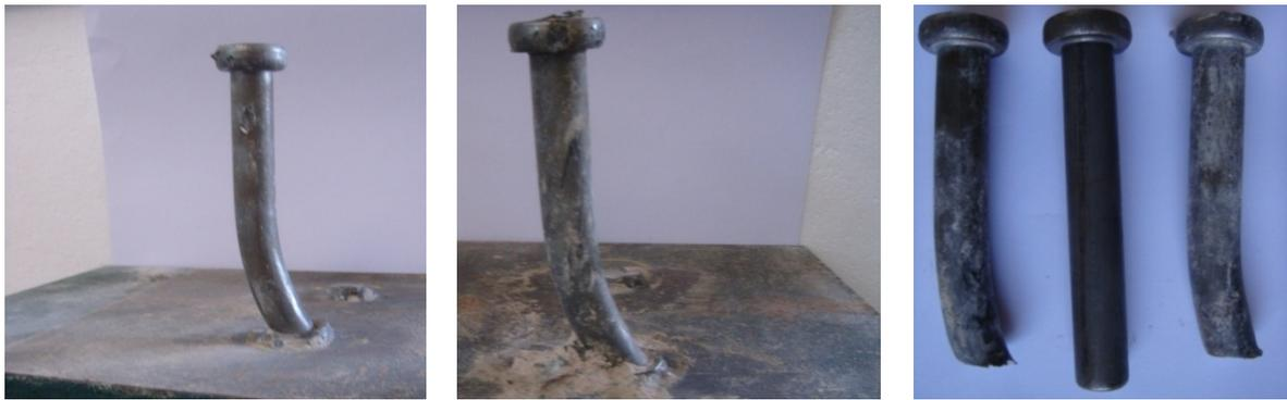
(a) Deformada do *stud* Posterior      (b) Deformada do *stud* Frontal      (c) *stud* rompido
