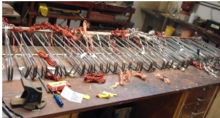
Figura 4.18 - Armaduras instrumentadas
