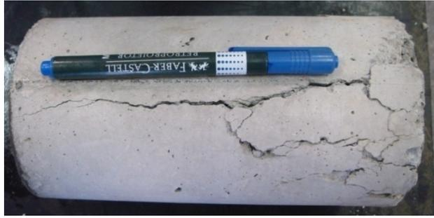
Figura 5.2 - Modelo de ruptura do corpo-de-prova de concreto para os ensaios finais
