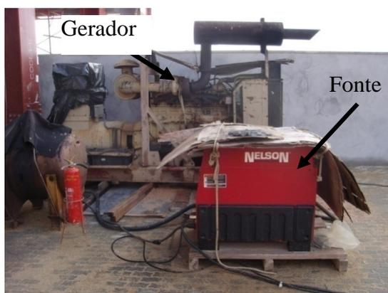
(a) Gerador e fonte elétrica para soldar o *stud*
