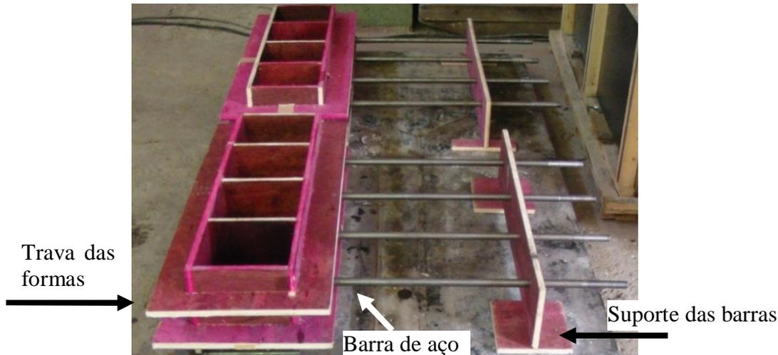
Figura 4.29 - Dois blocos para uso no ensaio de arrancamento
