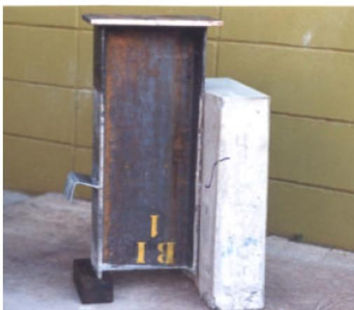
Figura 3.29 - Ensaio de *Push-out* realizado por Malite (1993) (Tristão, 2002)
