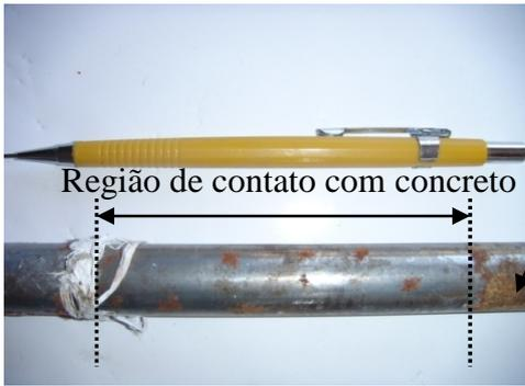
Barra com *pits* de corrosão (BL-02)
