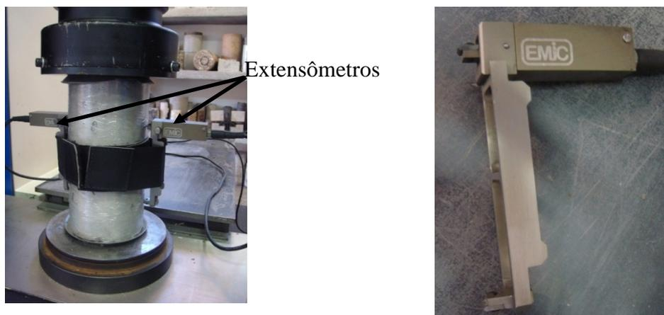
(a) Instrumentação do corpo-de-prova
