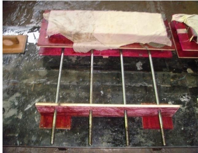
(b) Detalhe da cura dos blocos de arrancamento
