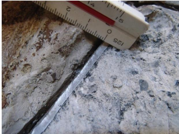
Figura 6.41 - Detalhe da abertura entre o conector ‘V’-2,65 mm e a laje
