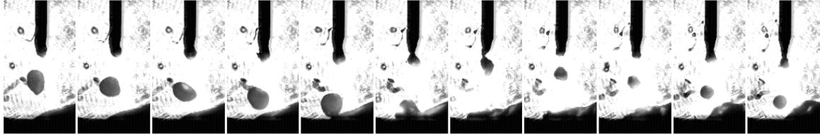
Figura 3.8. Modo combinado goticular projetado e globular. Ponto de trabalho: 28 V e 5.5 m/min.
