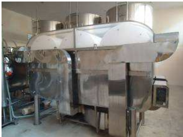
Fotografia 6 – Equipamento Desumificador para mel instalado na Casa Apis. Data: 2010. Autor e Fonte: Casa Apis.
