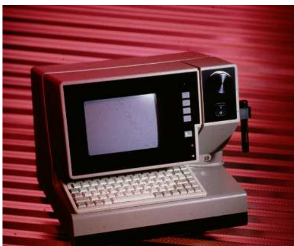
Figura 14: Aparelho de ultra-sonografia ocular mentor advent multifrequency 7,5; 11 e 15 MHz
