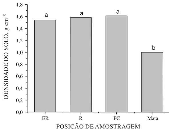
**Figura 2.** Densidade do solo nas diferentes posições de amostragem de um Latossolo Vermelho-Amarelo sob pomar de laranja (ER, R e PC) e sob mata, na camada de 0–0,12 m. Médias seguidas pela mesma letra não diferem entre si pelo teste de Tukey a 5 %.
