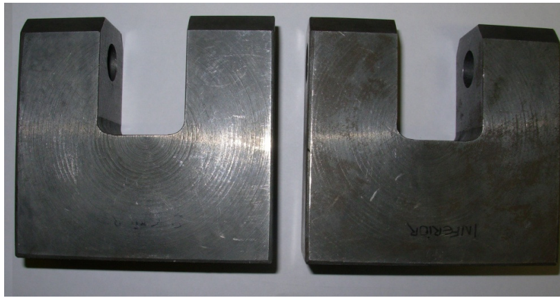
Figura C.8. Garra Clevis utilizada no ensaio de tenacidade a fratura.
