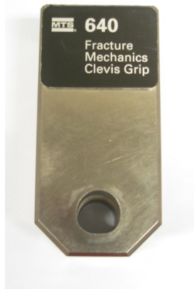
Figura C.6. Garra superior da Clevis .
