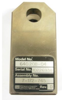
Figura C.7. Garra inferior da Clevis .
