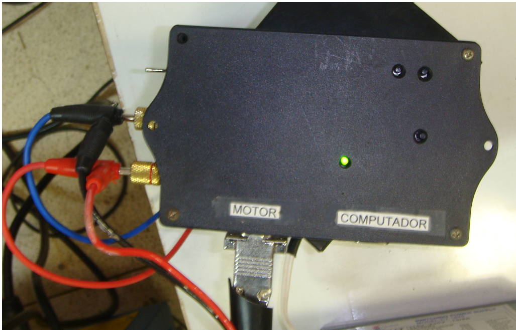
Figura 27 - Controladora da mesa posicionadora.
