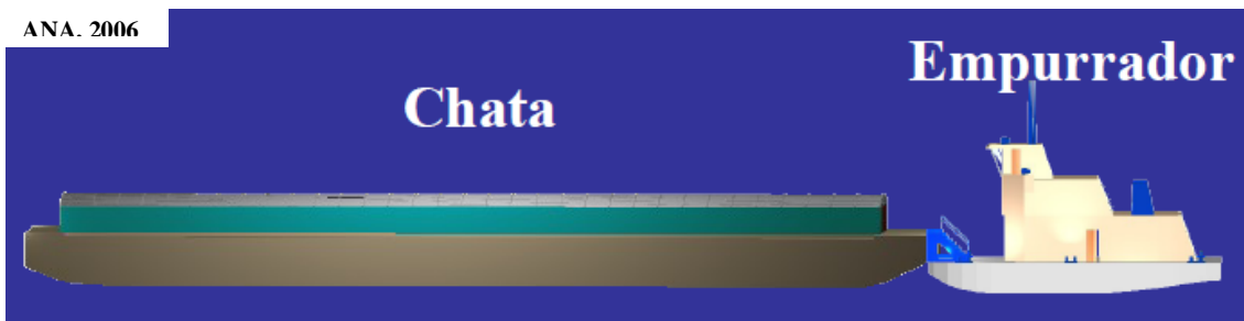
Figura 5 - Embarcação adotada na navegação do Rio Tocantins, empurrador: 18,3m x 8,0m e chata: 45,0m x 8,0m
