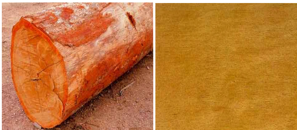
Figura 2.4.4 – Tora e detalhe do corte transversal do Louro ( Ocotea sp. )
