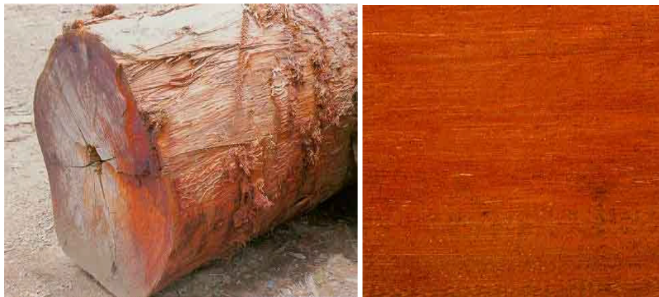
Figura 2.4.2 – Tora e detalhe do corte transversal do Angelim-vermelho ( Dinizia excelsa ).
