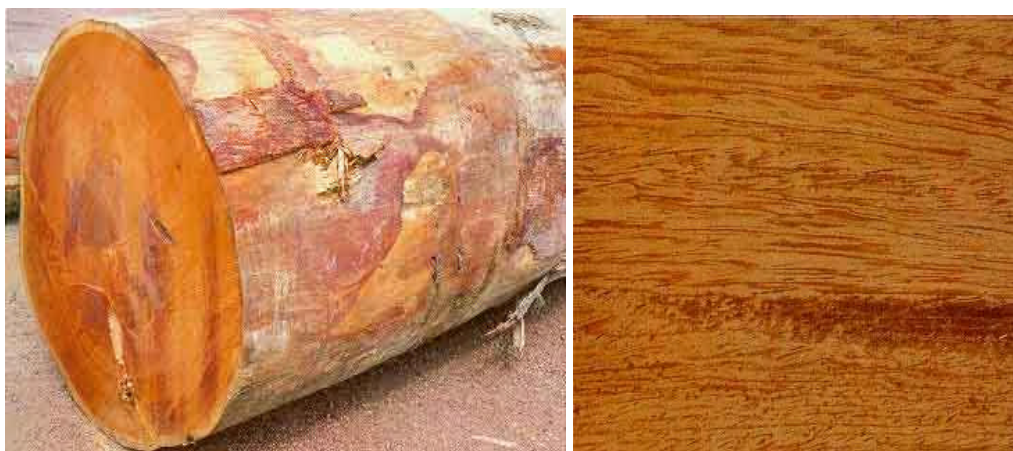
Figura 2.4.1 – Tora e detalhe do corte transversal de Angelim-pedra ( Hymenolobium petraeum ).
