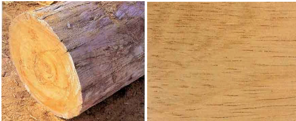
Figura 2.4.3 – Tora e detalhe do corte transversal do Cedro ( Cedrela odorata ).
