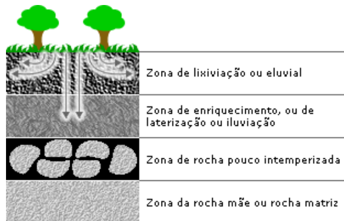
Figura 3.28 – Exemplo de processo de lixiviação.
