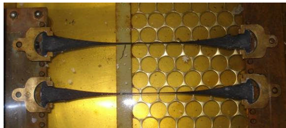
Figura 3.14 - Amostras alongadas durante o ensaio de ductilidade.
