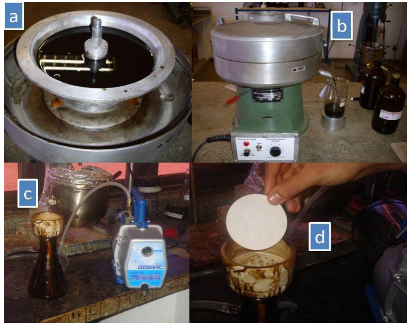
Figura 3.4 - (a) Cuba do Rotarex com a mistura fresado-solvente (b) Equipamento Rotarex (c) Kitasato e bomba de vácuo (d) detalhe do funil de Buchner com filtro
