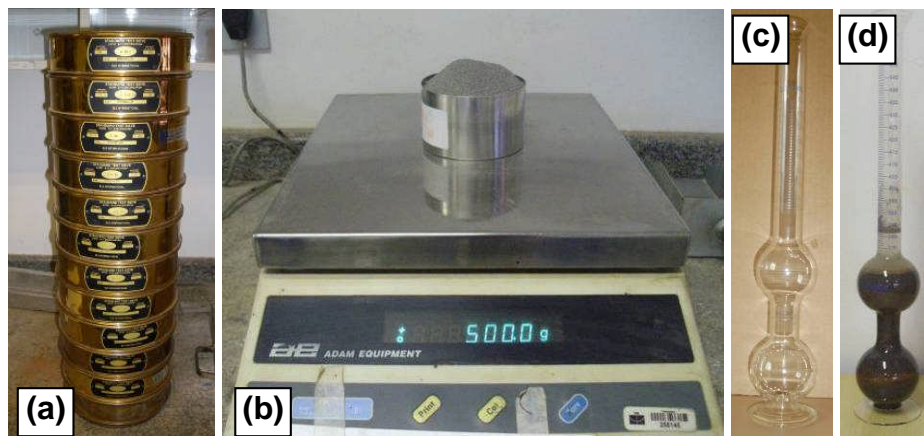
Figura 3.8 - Determinação do peso específica do pó-de-pedra: (a) seleção por peneiramento, (b) pesagem do material, (c) Frasco de Chapman ; (d) Frasco de Chapman após ensaio.
