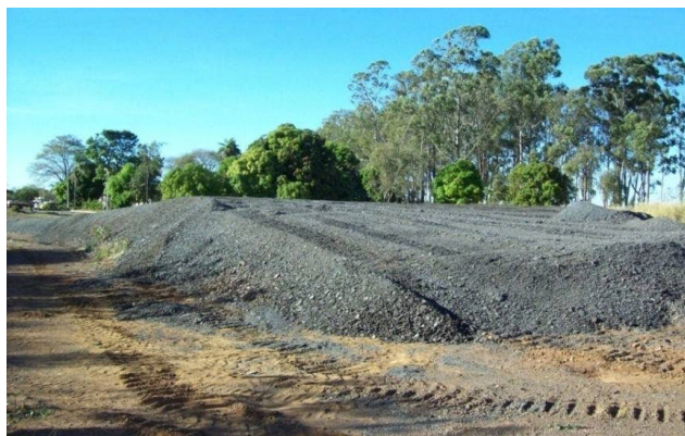
Figura 2.7 - Depósito de fresado no pátio do 2ºDR em 2010.
