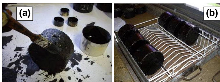
Figura 3.31- Corpos de prova com “RejuvaSeal”: (a) processo de revestimento; (b) Em repouso
