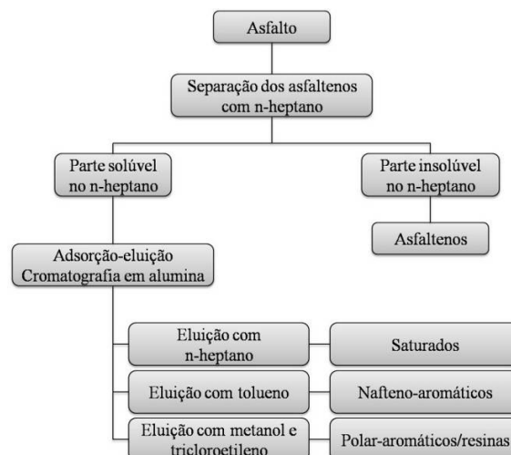
Figura 2.10 - Principais etapas do fracionamento do ligante asfáltico (Souza, 2010)
