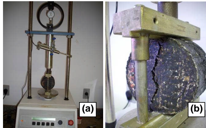
Figura 3.24 - Equipamento do ensaio de Resistência à Tração por compressão diametral: (a) Visão geral do equipamento; (b) Ruptura de um corpo de prova
