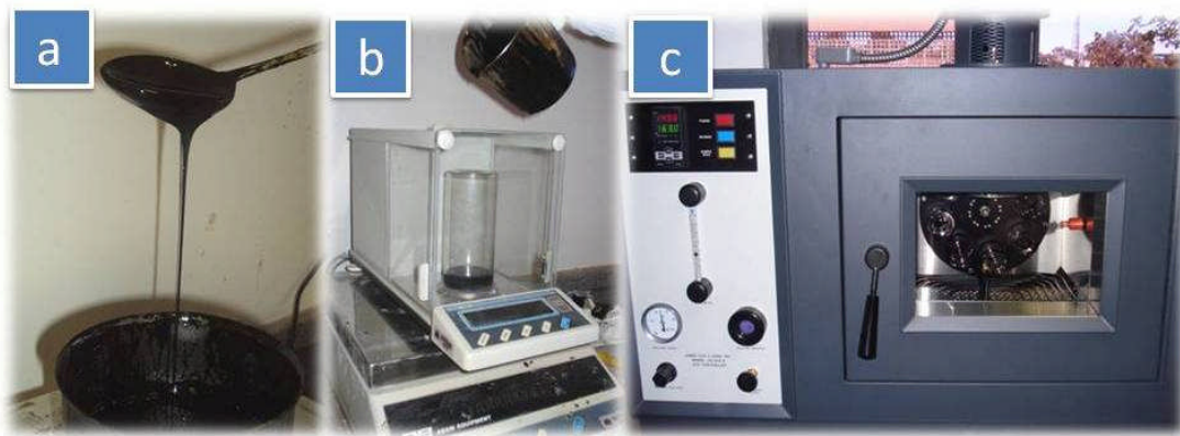
Figura 3.17 - (a) Preparação e (b) Pesagem da amostra; (c) Estufa RTFOT
