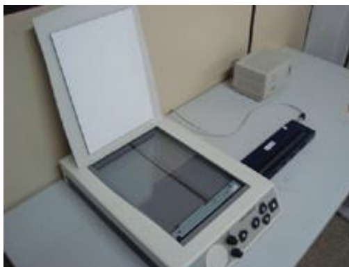
Figura 10 - Equipamento leitor de Documentos ( Poet Compact ) com voz sintetizada em português
