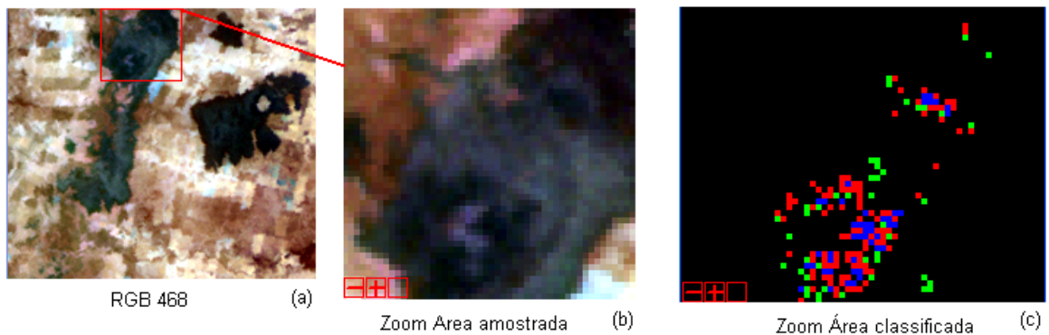
Figura 5.18- Classificação espectral, pelo método SAM, dos calcários e dolomitos da área 1.(a) composição RGB 468, (b) zoom da área amostrada e (c) resultado da classificação SAM utilizando ângulos múltiplos.
