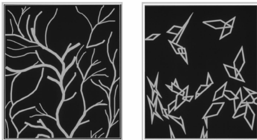
Figura 13– Representação da estrutura morfológica de óleo lubrificante com o uso de aditivo abaixador do ponto de fluidez. 19
