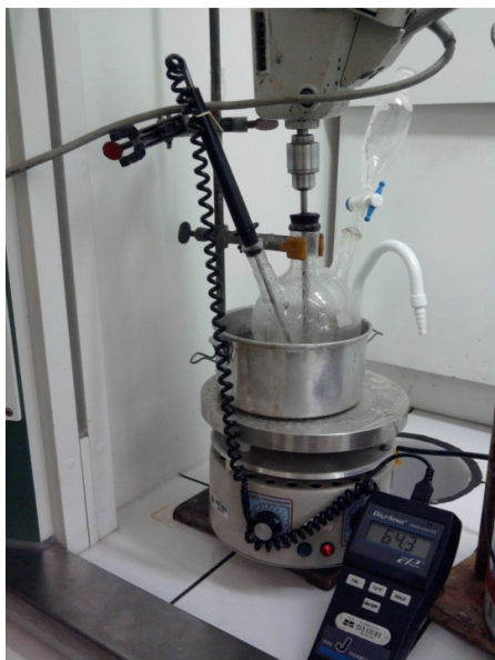
Figura 15. Ilustração da montagem do sistema para a reação de hiroxilação do óleo de maracujá.
