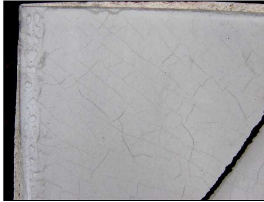
Figura 2.42 – Detalhe de cerâmica gretada (LEM- UnB, arquivo fotográfico).
