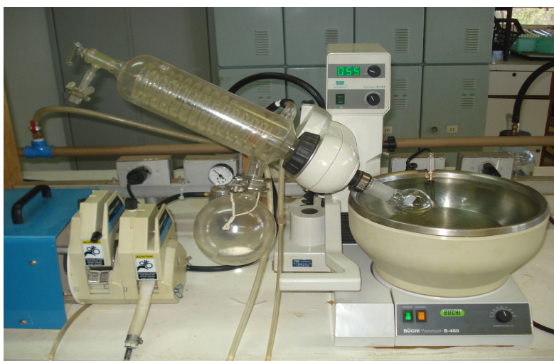
Figura A.3 – Aparelho de rotavapor que foi utilizado na evaporação do ácido acético e do metanol durante o processo de semipurificação das amostras de saxitoxinas
