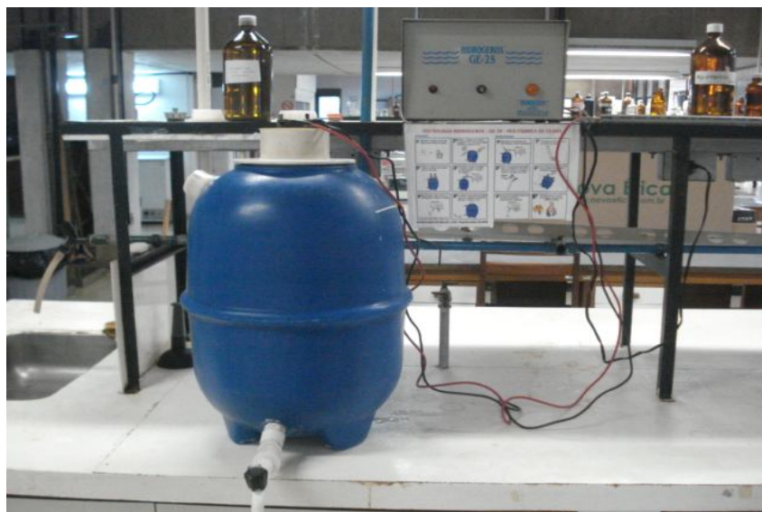
Figura 4.5 – Equipamento gerador de solução de cloro
