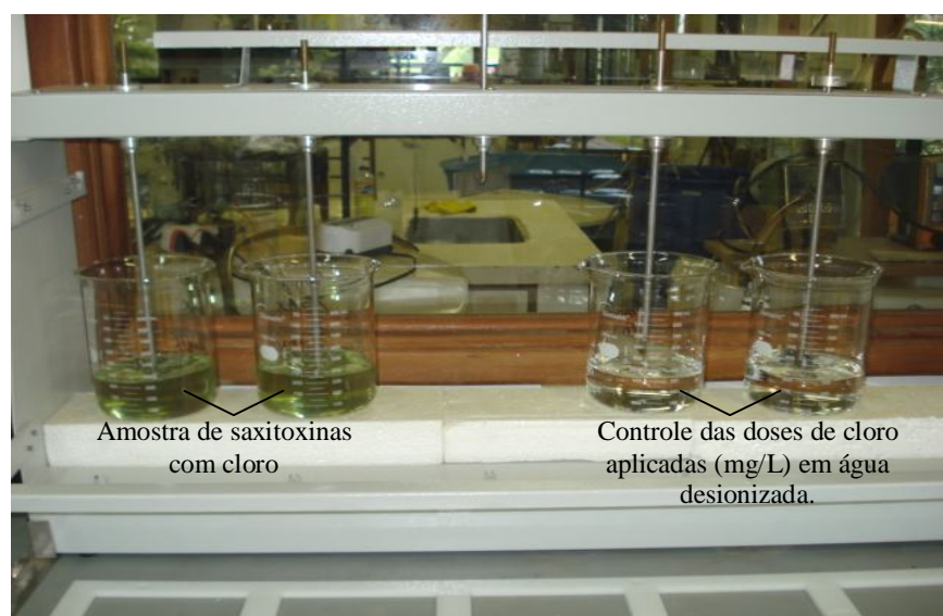
Figura 4.6 – Experimento com saxitoxinas e controle de doses de solução oxidante
