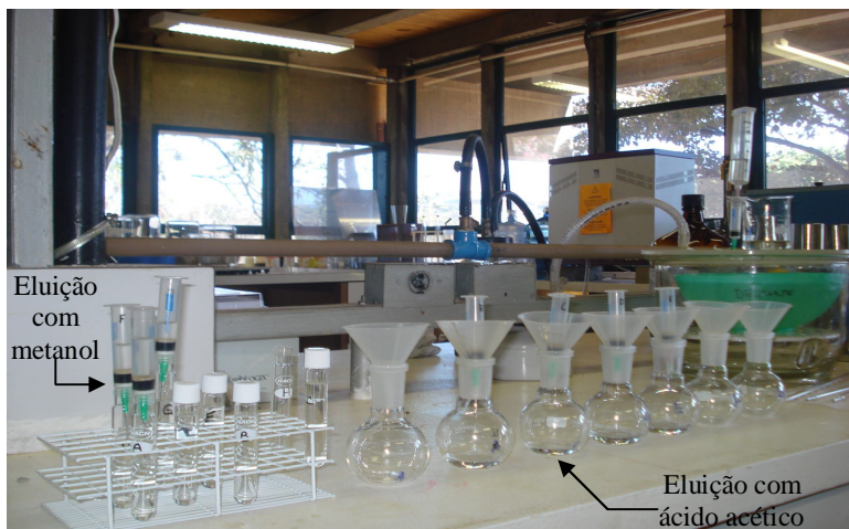
Figura A.2 – Etapa do processo de eluição com metanol e com ácido acético
