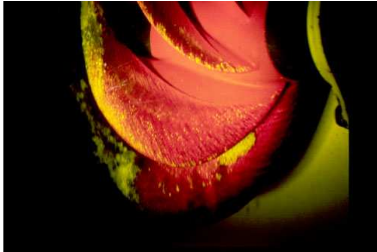
Figura 1.3: Exemplo de erosão causada pela cavitação em pás de um propulsor.
