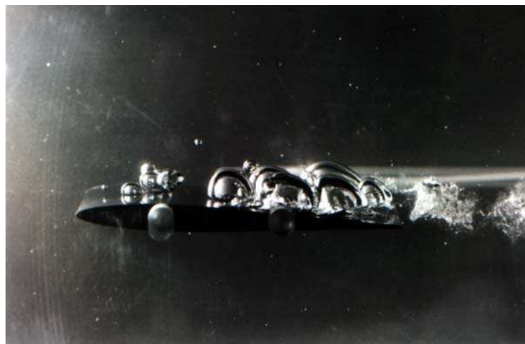
Figura 1.1: Cavitação hidrodinâmica de bolhas.
