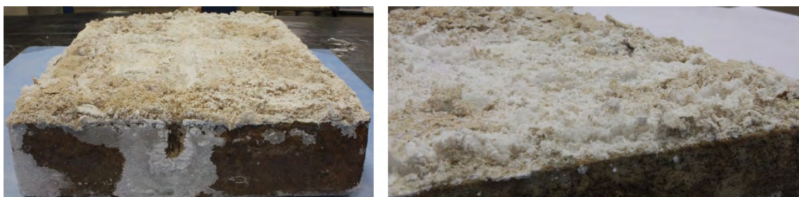
Figura 3.44 – Eflorescências formadas durante o ciclo de exposição inicial à solução saturada de \text{Na}_2\text{SO}_4 – ADG1SB em detalhe
