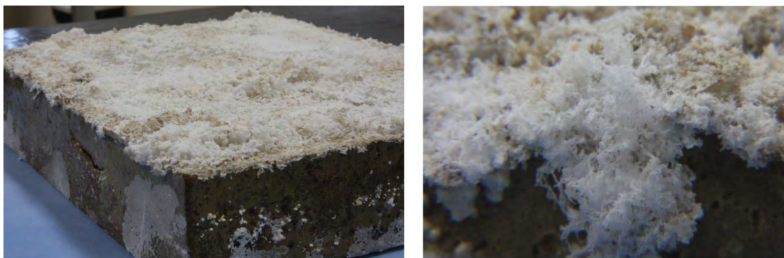
Figura 3.45 – Eflorescências formadas durante o ciclo de exposição inicial à solução saturada de \text{Na}_2\text{SO}_4 – ADG2CB em detalhe
