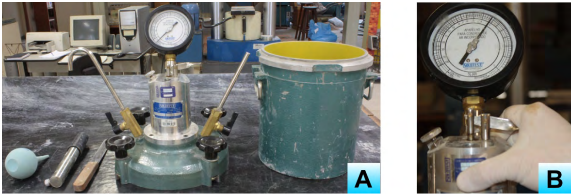
Figura 3.22 – Determinação do teor de ar incorporado (A – equipamento e B – leitura no manômetro)
