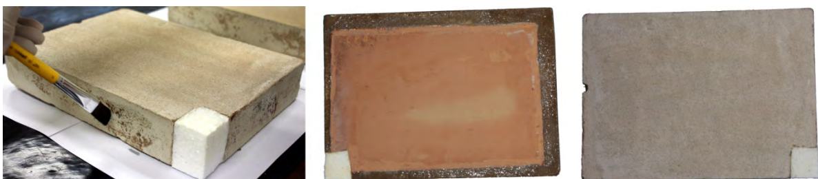
Figura 3.41 – Aplicação de adesivo epóxi no corpo-de-prova para orientar o fluxo da solução em estudo
