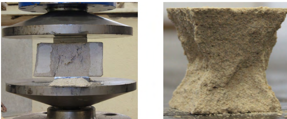
Figura 3.27 – Determinação da resistência à compressão
