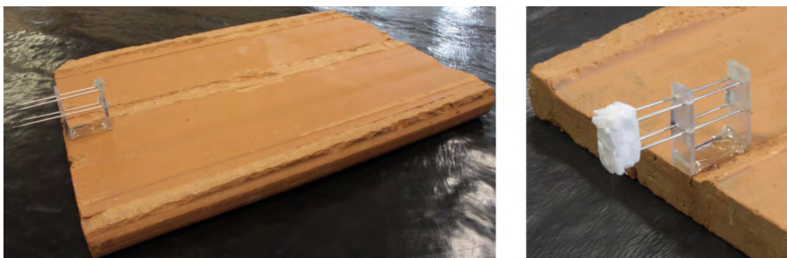
Figura 3.38 – Substrato com sensor de umidade instalado
