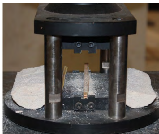
Figura 3.26 – Determinação da resistência à tração por compressão diametral
