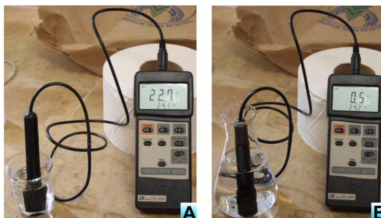
Figura 3.13 – Condutividade elétrica da água empregada na análise do teor de sulfatos (A – água destilada e B – água filtrada, destilada e deionizada)
