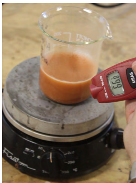
Figura 3.15 – Procedimento empregado na extração do sulfato das amostras
