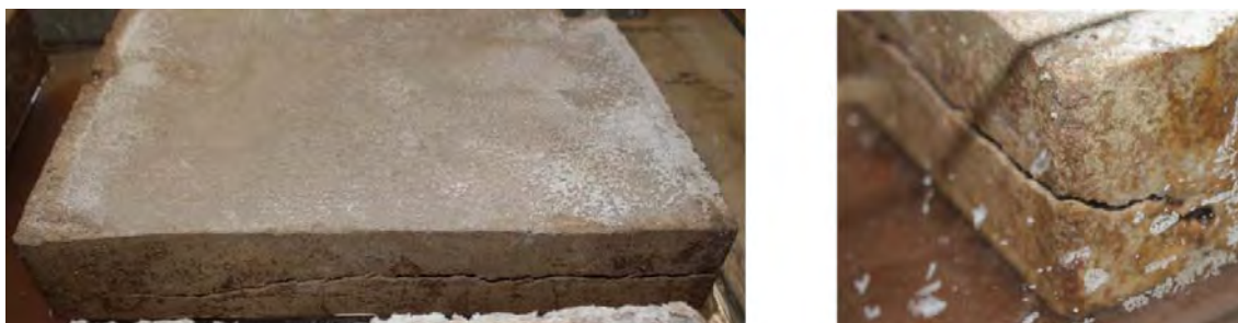
Figura 3.43 – Danos provocados pelas florescências aos corpos-de-prova durante o ciclo de exposição inicial à solução saturada de \text{Na}_2\text{SO}_4
