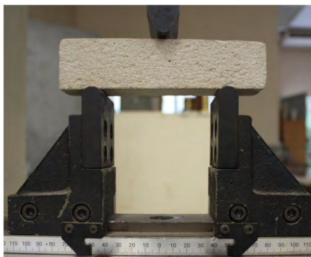
Figura 3.25 – Determinação da resistência à tração na flexão
