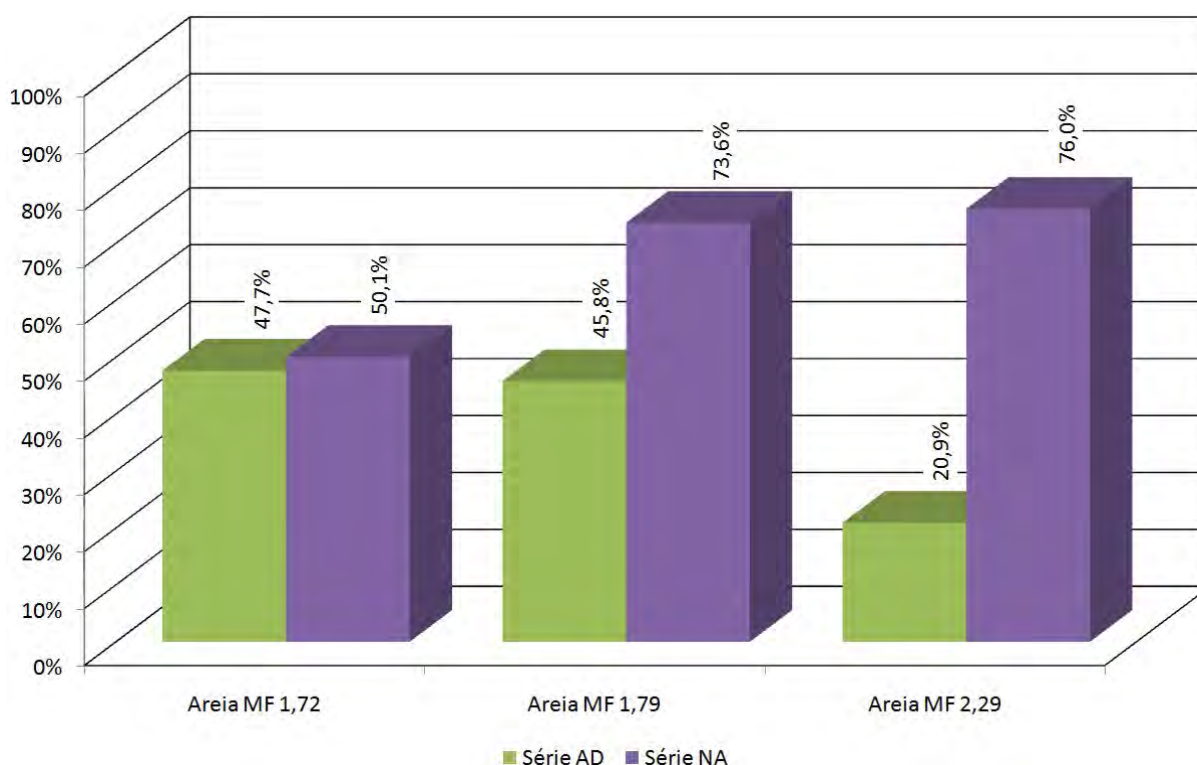
Figura 4.32 – Redução da massa de sal eflorescido proporcionada pela película de barreira, em relação às séries ADSB e NASB
