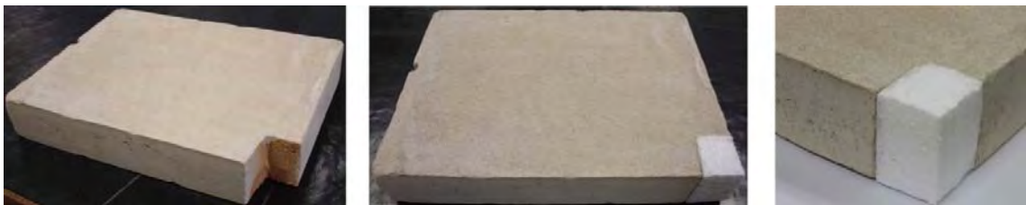
Figura 3.40 – Extração de amostra para porosimetria e restauração da seção com EPS
