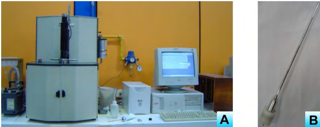
Figura 3.28 – Porosímetro Quantachrome, modelo PoreMaster 33 empregado (A – vista geral do equipamento e B – porta-amostra em detalhe) (fonte: Laboratório de Materiais de Construção da UNISINOS)
