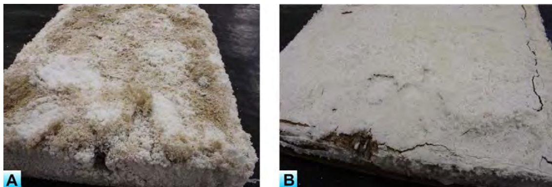
Figura 4.48 – Configuração geral das eflorescências formadas na superfície das séries após o ciclo de exposição final (A – NAG3SB e B – ADG1CB)
