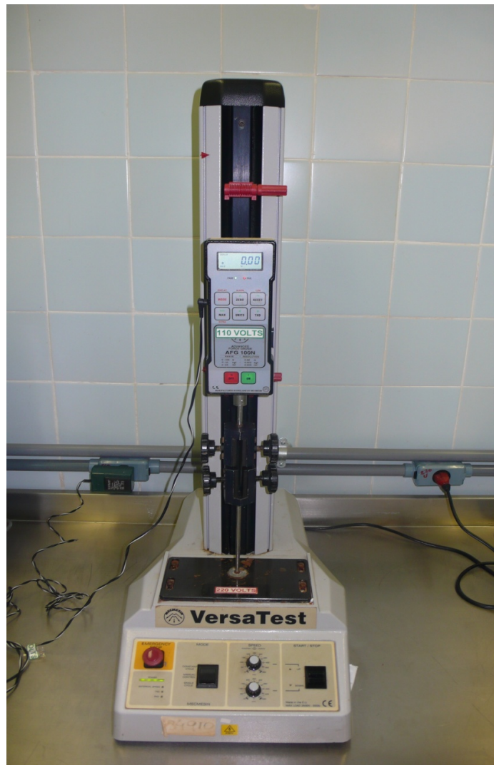
FIGURA 10 – APARELHO DE ENSAIO VERTICAL (VERSA TEST) ACOPLADO AO DINAMÔMETRO DIGITAL
