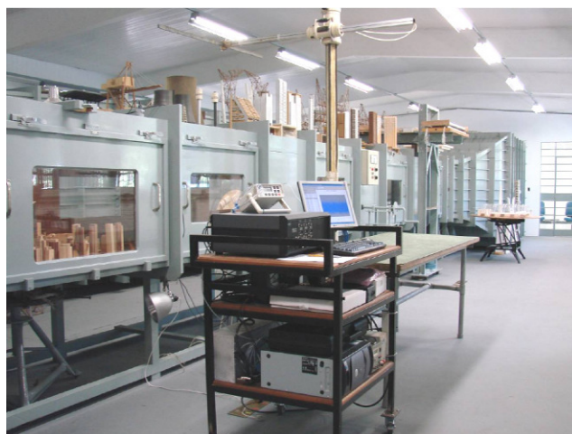
Figura 3.1: Vista externa do túnel de vento Prof. Joaquim Blessmann 1 .
