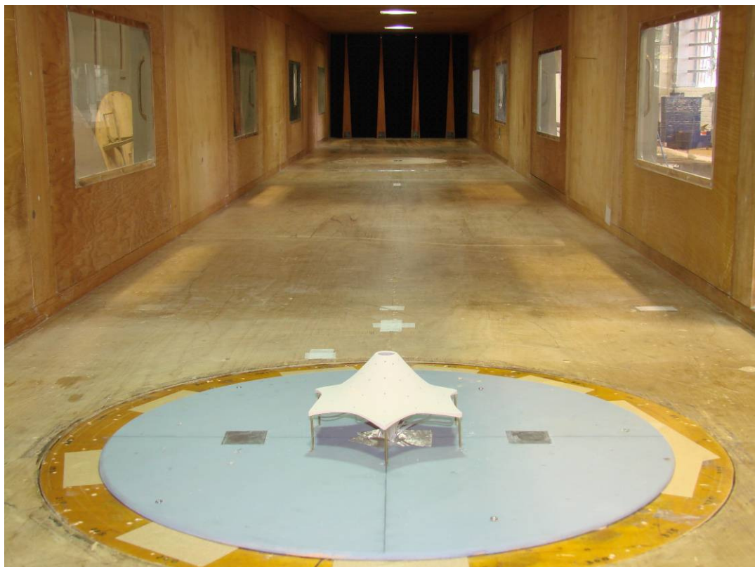
Figura 3.5: Modelo da tensoestrutura R0305 montado dentro do túnel de vento para medição de pressões externas.
