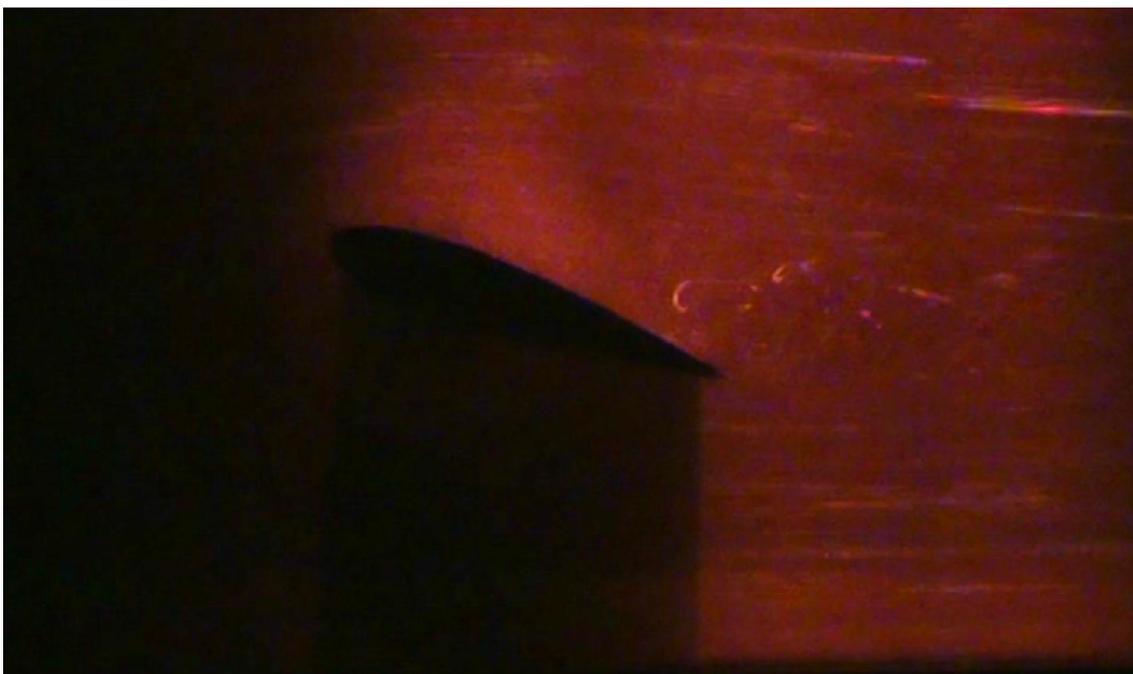
**Figura 4-50 - Visualização do escoamento, caso dinâmico,  $Re=150.000$ ,  $\omega=0,19$  rad/s e  $\alpha=19^\circ$**
