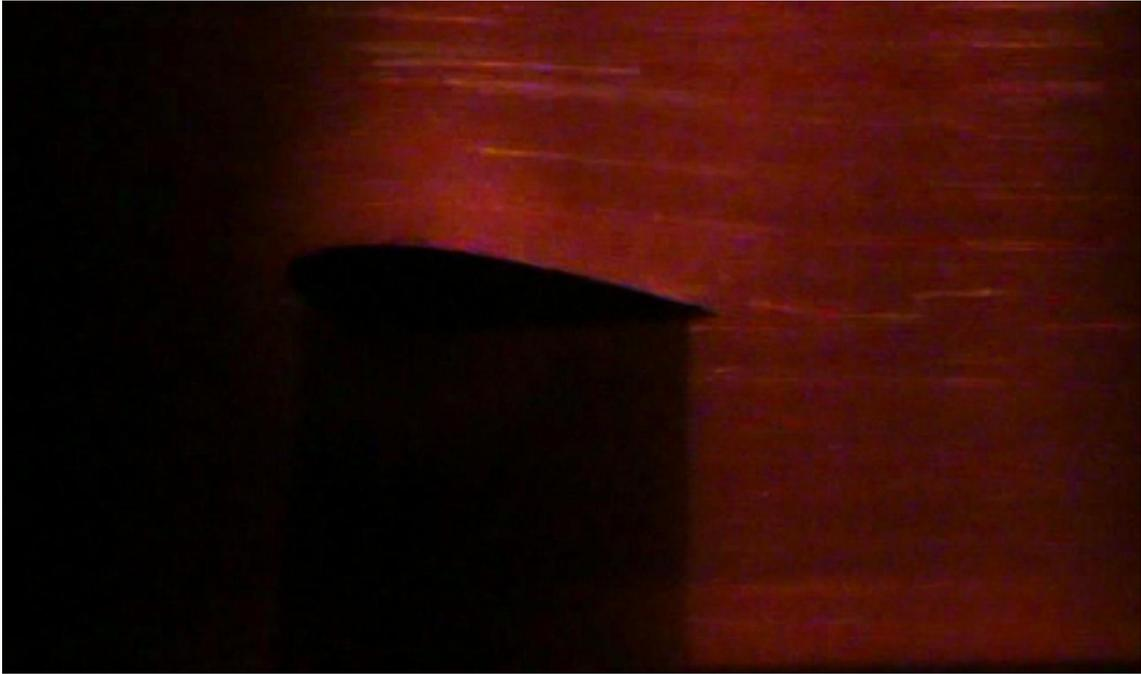
Figura 4-41 - Visualização do escoamento, caso dinâmico,  $Re=150.000$ ,  $\omega=0,13$  rad/s e  $\alpha=7^\circ$
