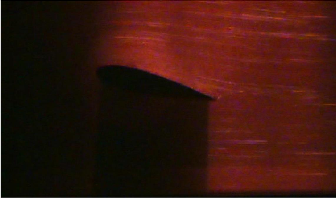
Figura 4-47 - Visualização do escoamento, caso dinâmico,  $Re=150.000$ ,  $\omega=0,19$  rad/s e  $\alpha=10^\circ$
