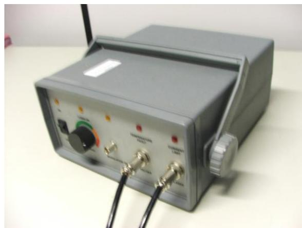
Figura 3-16 - Fonte de alimentação do emissor de laser
