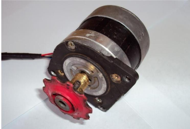
**Figura I-12 - Motor de passo**
