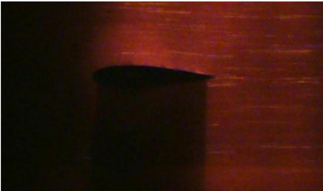
**Figura 4-45 - Visualização do escoamento, caso dinâmico,  $Re=150.000$ ,  $\omega=0,19$  rad/s e  $\alpha=0^\circ$**
