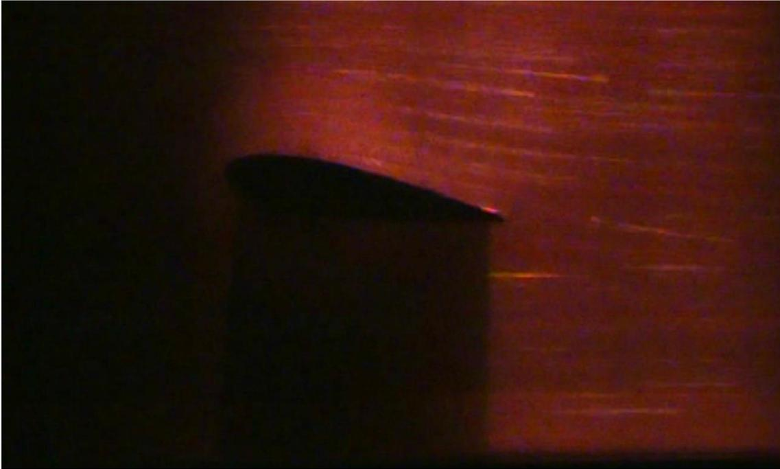
**Figura 4-35 - Visualização do escoamento, caso dinâmico,  $Re=150.000$ ,  $\omega=0,06$  rad/s e  $\alpha=10^\circ$**
