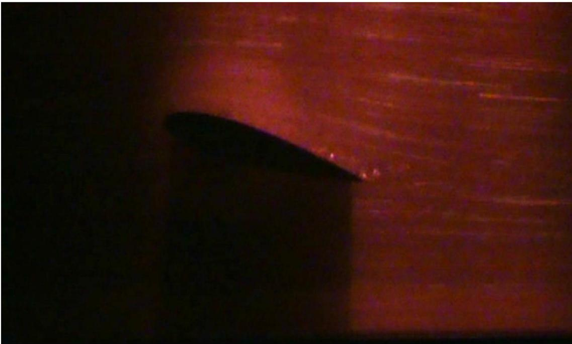
**Figura 4-37 - Visualização do escoamento, caso dinâmico,  $Re=150.000$ ,  $\omega=0,06$  rad/s e  $\alpha=17^\circ$**
