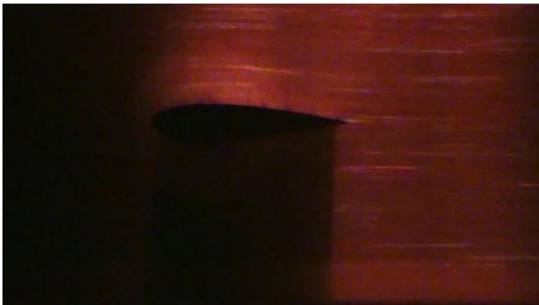
Figura 4-33 - Visualização do escoamento, caso dinâmico,  $Re=150.000$ ,  $\omega=0,06$  rad/s e  $\alpha=0^\circ$
