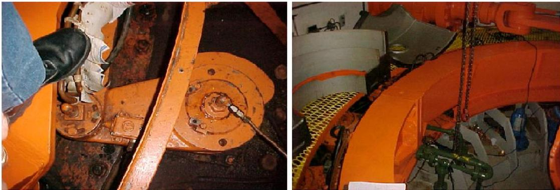
**Figura 1-3 - Sistema biela-manivela de acionamento do anel distribuidor**
