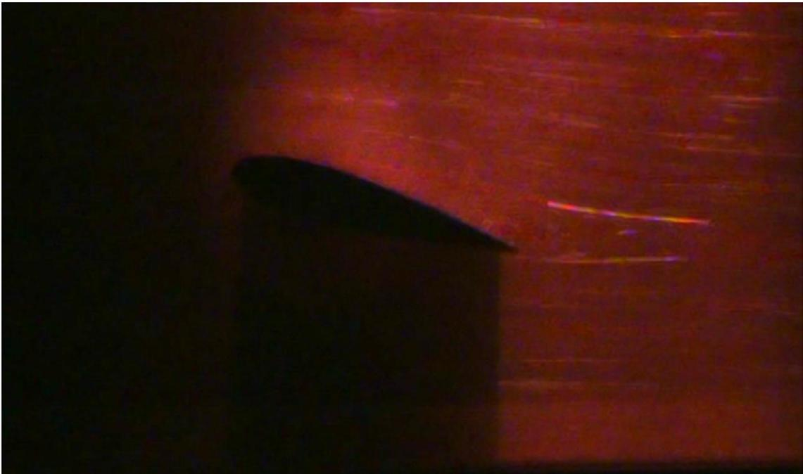
Figura 4-48 - Visualização do escoamento, caso dinâmico,  $Re=150.000$ ,  $\omega=0,19$  rad/s e  $\alpha=15^\circ$
