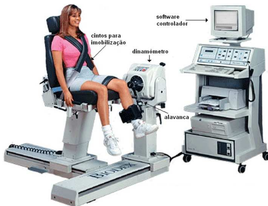
Figura 2.2: Sistema de dinamometria isocinética Biodex System 3 Pro (modificado – Biodex, 1998).
