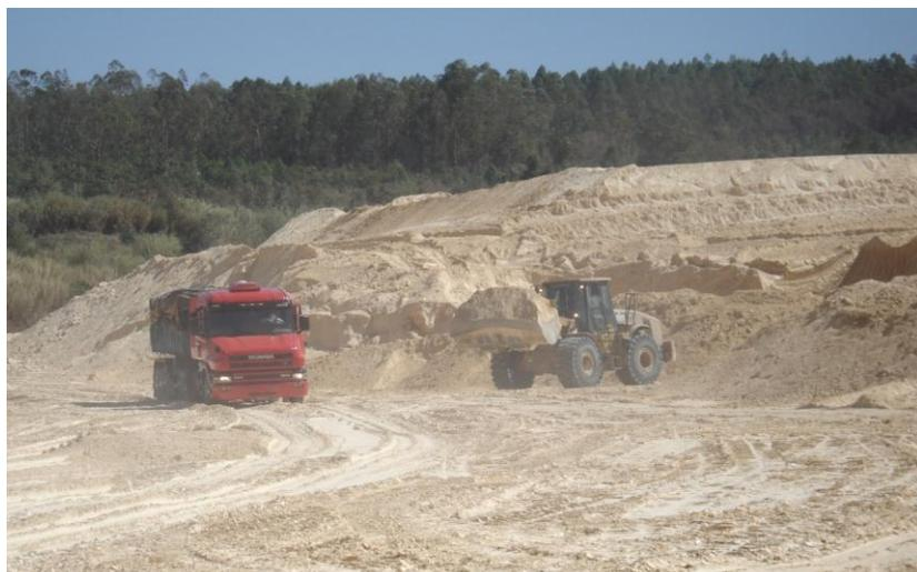
Figura 2.9 - Formação de pilhas de fosfogeno di-hidratado pela deposição a seco.
