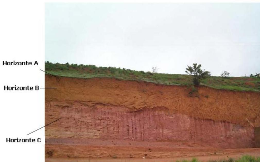
Figura 2.11 - Perfil de solo com evidente distinção entre os horizontes A, B (laterítico) e C (saprólítico) (Marangon, 2004).
