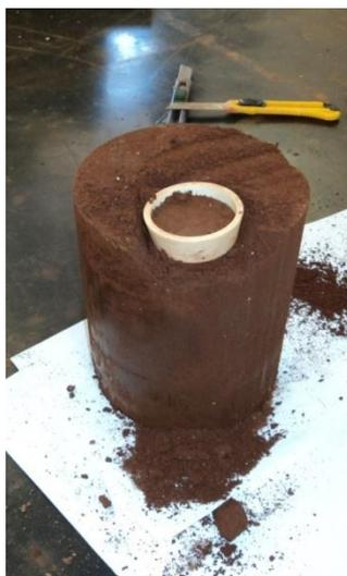
Figura 3.10 - Moldagem dos corpos de prova utilizados no método do papel filtro.
