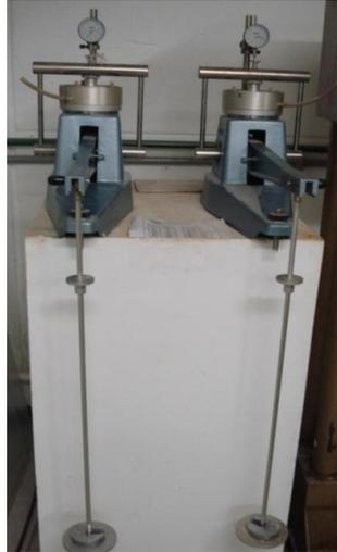
Figura 3.5 - Prensas de adensamento utilizadas.
