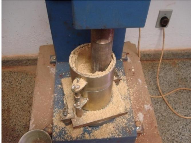
Figura 3.4 - Uso do aparelho automático de compactação.
