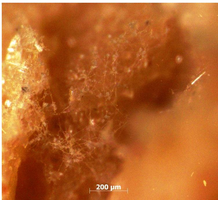
Figura 4.40 - Microfotografia do fosfогesso adensado.
