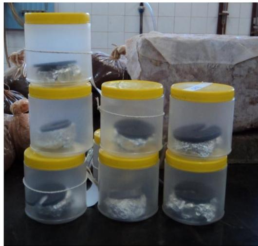
Figura 3.11 - Corpos de prova embalados e armazenados em vasilhames de plástico.
