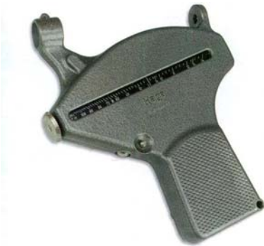
Figura 10. Hipsômetro de Haga de Blume Leiss
