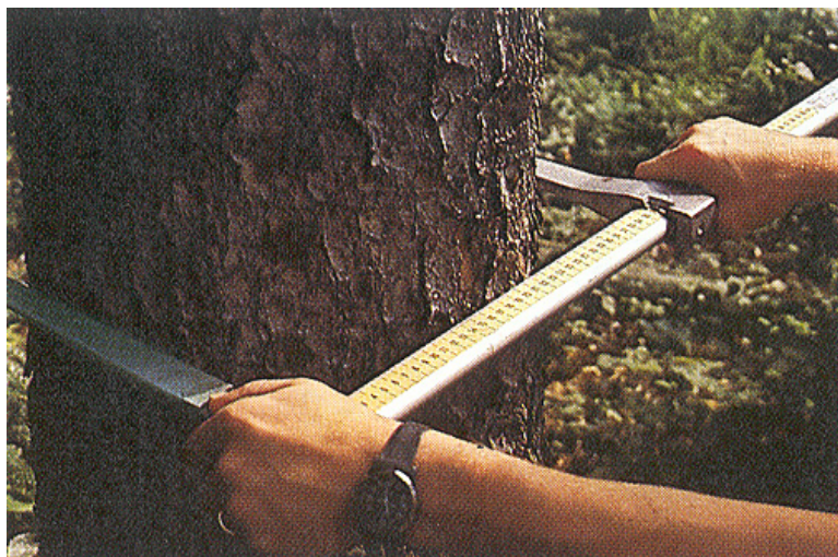
Figura 7. Suta ou paquímetro florestal
