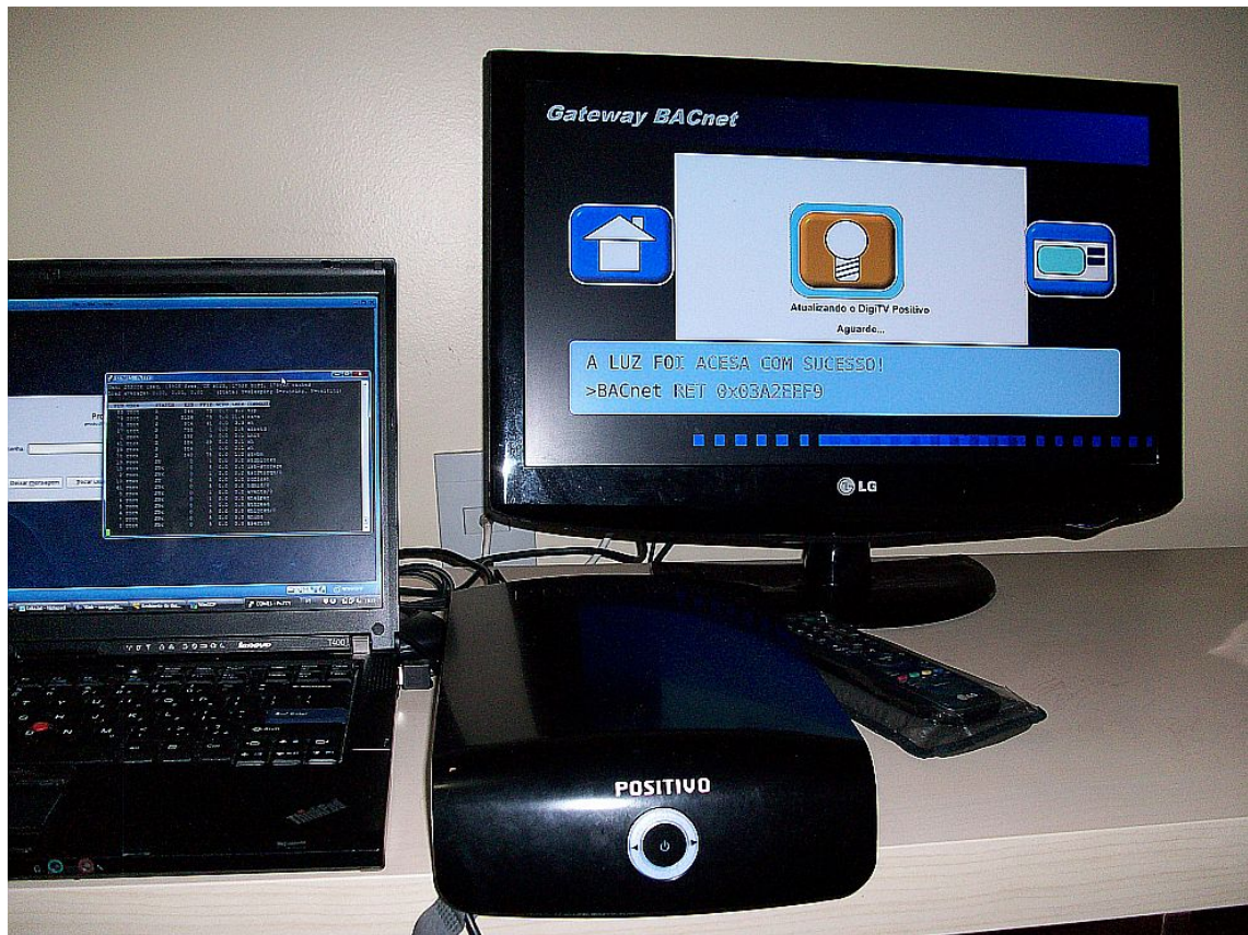
Figura 4.4: Tela do Navegador X em execução no STB comercial apresentado em uma TV LCD
