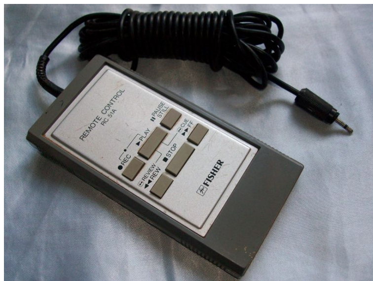
Figura 1.1: Controle remoto Fisher a fio. Acervo próprio do autor.
