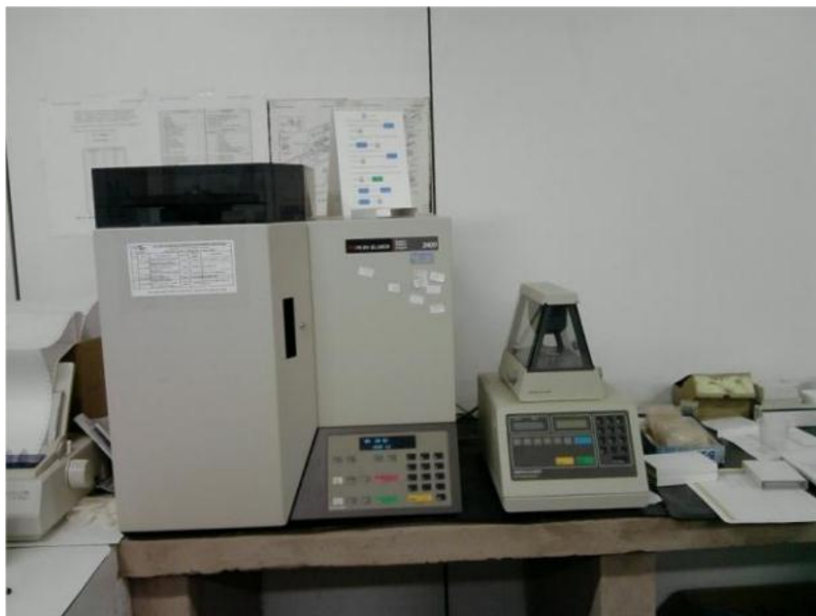
Figura 4.9: Analisador elementar - Perkin Elmer, PE-2400 Séries II - no laboratório de solos da Embrapa Cerrados.
