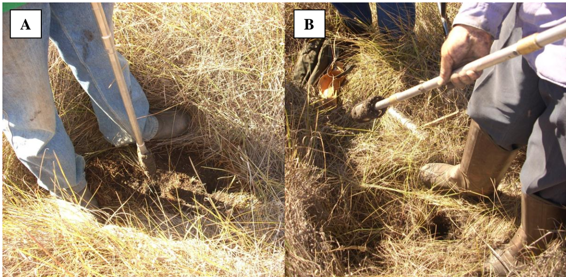
Figura 4.7: (A) Coleta deformada de solo utilizando trado holandês e (B) Coleta indeformada de solo utilizando trado com anel volumétrico.
