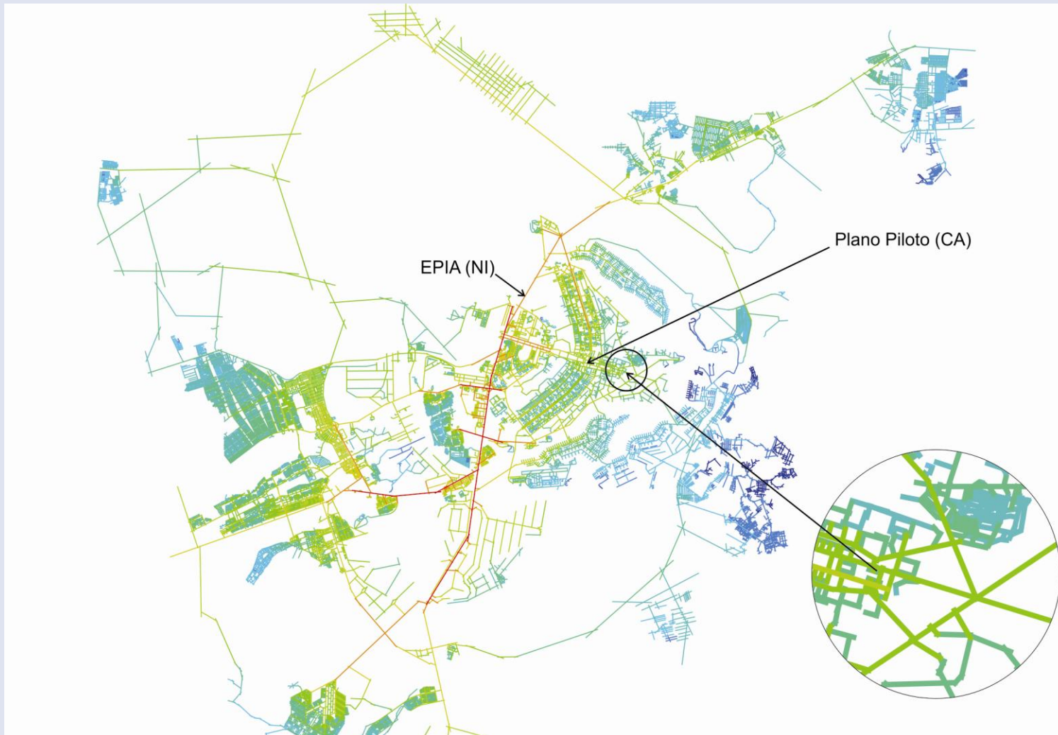
Figura 212- Mapa axial atual de Brasília e entorno. A EPIA pertence ao Núcleo de Integração (NI) enquanto o Plano Piloto, que está identificado como centro antigo (CA), está fora dele. O círculo identifica a região da Praça dos Três Poderes, sendo que os eixos que levam até a praça apresentam valores de integração medianos (cor verde, como se pode ver no detalhe).Crédito: Valério Medeiros.
