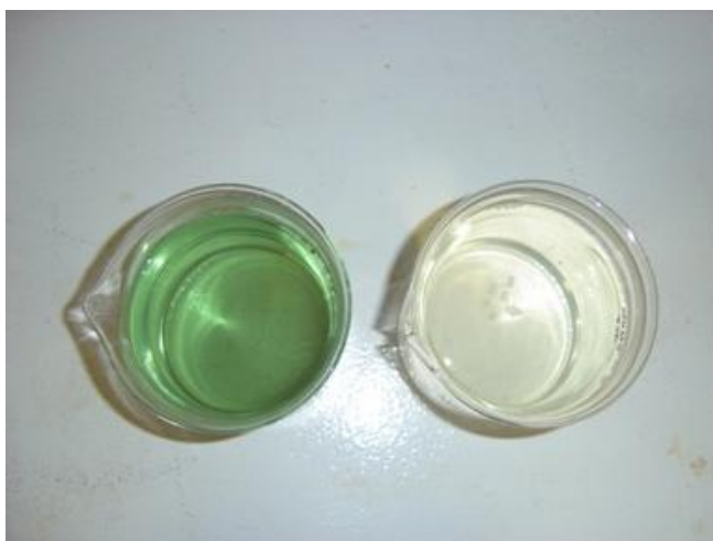
Figura 5.12 – Amostras contendo saxitoxinas antes do contato com cloro (direita) e após 10 minutos de contato com aproximadamente 8 mg/L de cloro livre (esquerda).
