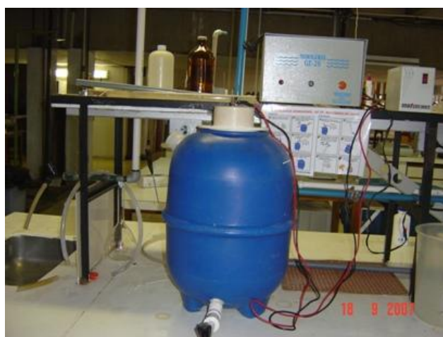
Figura 4.5 – Gerador de cloro.
